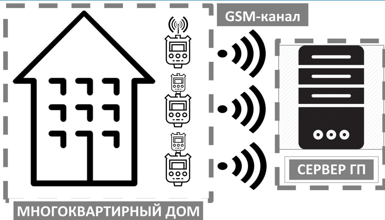
Трёхуровневая архитектура АСКУЭ (ИСУЭ), используемая ПАО «ТНС энерго Марий Эл», предполагает передачу данных от ПУ по внутридомовым электрическим сетям на концентратор (технология PLC), который по GSM-каналу транслирует их на сервер ГП с установленным ПО верхнего уровня.
